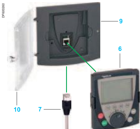
Abgesetztes Grafikterminal in Schaltschranktür eingebaut: 6 + 7 + 9 bei IP 54, 6 + 7 + 9 + 10 bei IP 65
