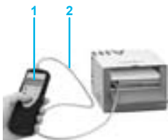
Konfiguration des Umrichters in seiner Verpackung mit dem „Multi-Loader“-Tool VW3 A8 121+ Kabel VW3 A8 126
